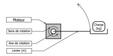
Un moteur qui possède un couple de 15 m.kg serait théoriquement capable de **relever une charge de 1** kg au bout d'un levier de 15 m, ou bien une charge de 15 kg au bout d'un levier de 1 m, ou bien une charge de 3 kg au bout d'un levier de 5 m ...
